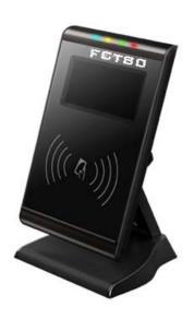
FCT80 是一款带显示屏的电子现金消费终端,适合城市通卡、市民卡、城市公交卡、银联闪付卡等小额消费卡片的柜面刷卡消费和查询业务。设备采用 USB 口或串口供电及通讯,可选无线通讯模块,同时设备底座灵活多变,既减少了商户柜台的线缆数量,又极大的方便设备的部署摆放。
